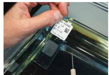
Étiquettes résistantes à l'humidité, aux bains d'eau bouillante et aux températures de l'autoclave
